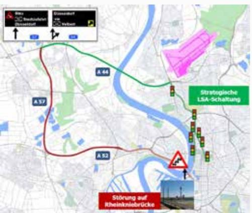
VTmanager.strategy ermöglicht die automatisierte Reaktion auf definierte Verkehrssituationen und Verkehrsmeldungen über workflowbasierte Strategien. Dabei haben die Strategien Zugriff auf die an VTmanager angebundenen Subsysteme und können beispielsweise Lichtsignalanlagen und Tafeln schalten sowie Verkehrsinformationen an Mobilitätsdienstleister weitergeben.
