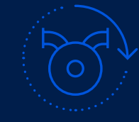
4 x 90° drehbarer Pumpenkopf
