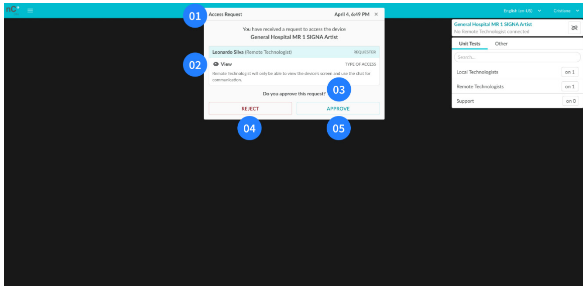
Figure 11: Écran principal local nCommand Lite avec notification de demande d'accès 01 – Titre (Access Request [Demande d'accès]) ; 02 – Nom du demandeur, rôle et description du type d'accès; 03 – Invite : « Do you approve this request? » (Approuvez-vous cette demande ?) ; 04 – Bouton Reject (Rejeter) ; 05 – Bouton Approve (Approuver)
