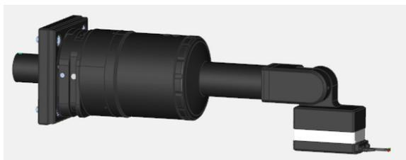
Der Sensor basiert auf einem **freitragenden Rauheitsmesssystem** mit eigener Messachse, wodurch die Maschine während der Messung stillsteht.
