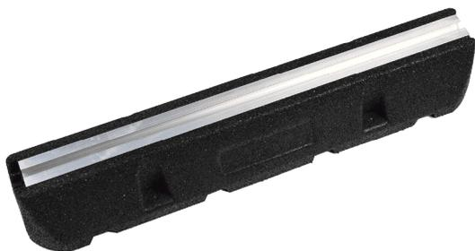
Base de suporte antivibrática para condensadores e bombas de calor. Carril em alumínio 21x15 mm e suporte em borracha reciclada. O Kit é composto por duas bases e pelos parafusos necessários à fixação da unidade ao carril (2 M10x30 parafusos, 2x M10 porcas & 2 M10x20 anilhas).
