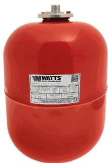
Vaso de expansão para sistemas de climatização, equipado com fole em EPDM, de modo a que não haja contacto entre a água do sistema e o vaso de aço. O vaso de expansão absorve as diferenças de pressão que ocorrem devido à expansão e contração da água num sistema fechado. O vaso de expansão deve ser montado o mais próximo possível da fonte ou bomba de calor na linha de retorno. Não deve ser montada qualquer válvula de fecho entre a fonte ou bomba de calor e o vaso de expansão.
