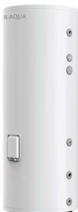
Depósito de água quente sanitária de serpentina única em aço inoxidável duplex com isolamento rígido e revestimento em aço. O permutador é dotado de uma elevada área de permuta da serpentina em ambos os modelos, tornando-a adequada para utilização em instalações de aquecimento a baixa temperatura com bombas de calor e caldeiras de condensação. Equipado de série com resistências imersas de 2kW, fornecidas sem controlo.
