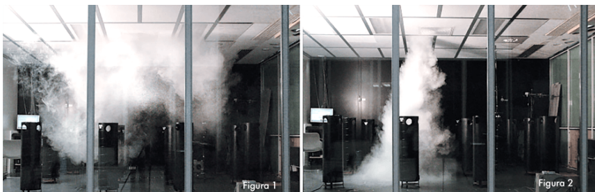
Figura 1: modo de calentamiento permanente; temperatura de impulsión 22 a 26° C;
