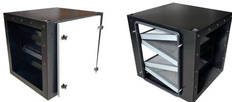
**Principio de funcionamiento:** el módulo de carbón no está equipado con un filtro antigrasa. No puede instalarse sin la protección contra la contaminación por grasa / partículas que proporciona el filtro electrostático de la serie Clean'Air Evo.
