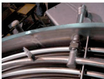
Sistema de inyectores fijos en la parte superior en el Vertigo® 2
