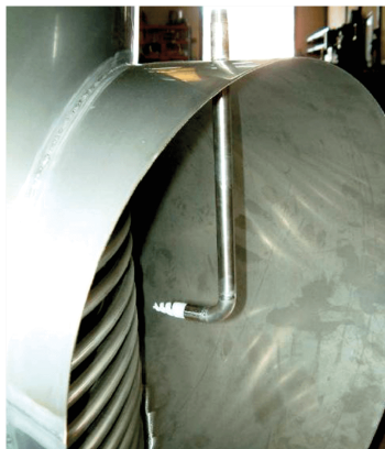
Injetor fijo en la entrada en el Vertigo® 2
