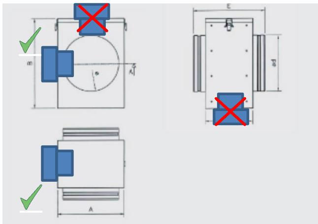
O Kalissia Air modelo 1 e 2 deve ser instalado numa superfície plana (conduta retangular). Quando isso não for possível, recomenda-se encomendar como acessório uma caixa C da gama France Air. É necessário instalar o Kalissia Air na face da caixa que está menos afastada da conexão circular, para que o ar passe através do dispositivo de ionização.
