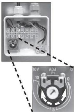
**NB:** ao ligar um potenciômetro ou um controlo externo, o potenciômetro instalado de fábrica deve ser desligado.
