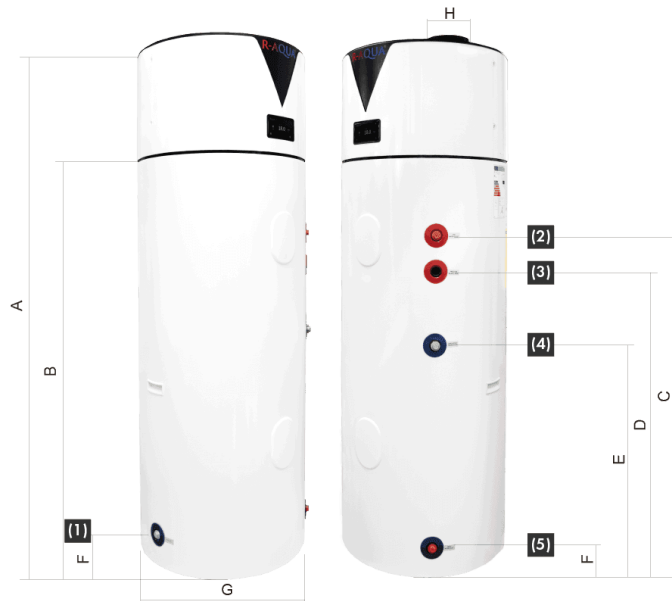
(1) Desagüe; (2) Salida de agua caliente; (3) Válvula de seguridad (presión); (4) Entrada de agua de circulación; (5) Entrada de agua fría;
