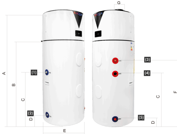
(1) Entrada de agua circulante; (2) Desagüe; (3) Salida de agua caliente; (4) Válvula de seguridad (presión); (5) Entrada de agua fría;
