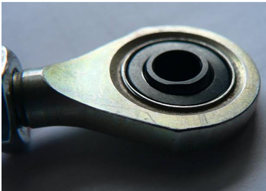
Obr. 2 Nevyhovující způsob zajištění ložiska v oku
