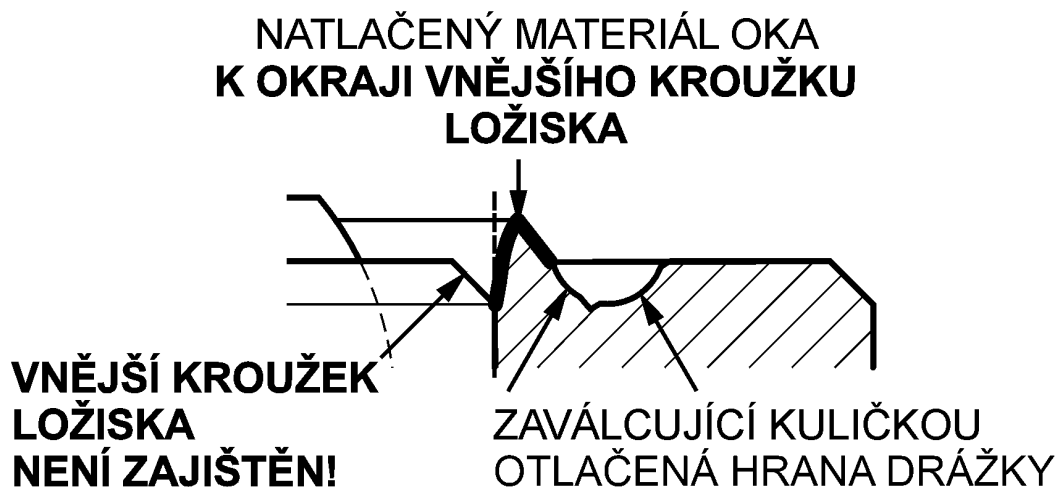
Obr. 3 Nesprávné zaválcování ložiska v oku táhla
