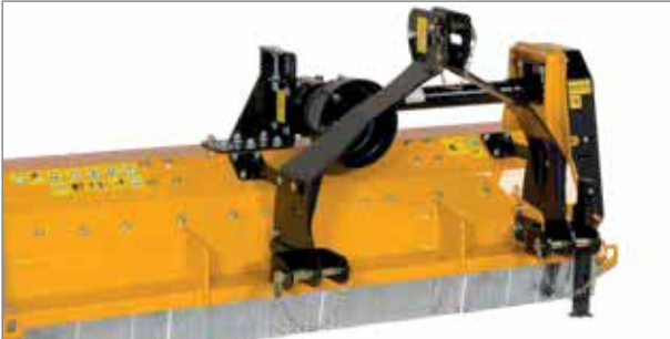
Der Anbaubock des MU-ECOTOP lässt sich durch Umschrauben hinter dem Traktor und seitlich dazu versetzt fahren.
