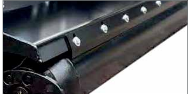
Der Abstreifer hält die Stützwalze sauber und reduziert die Staubeentwicklung (optional).
