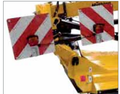
Warntafeln mit Beleuchtungseinrichtung und Beleuchtungsträger robust befestigt, ohne bewegliche Bauteile
