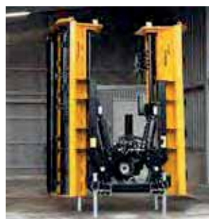
Dank durchdachter Bauweise lässt sich das MU-M/F Vario Mulchgerät platzsparend zusammengeklappt abstellen.
