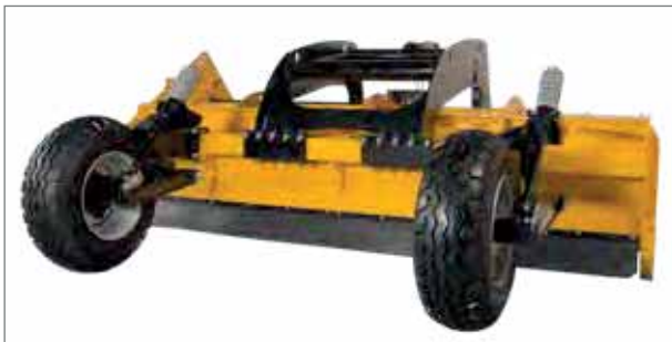
Bodenschonende Stützräder zur Höheneinstellung am MU-Farmer® für den Heckanbau. 180° schwenkbar für hohe Wendigkeit am Vorgewende. Ganzflächige Tiefenführung mit der großen Stützwalze am MU-Farmer® für den Frontanbau.
