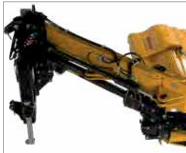
Aufgeräumt: die Schlauchverlegung.
