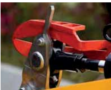
Die neue verstellbare hydraulische Schneidschiene Vario-Shift ermöglicht eine schnelle stufenlose Anpassung des Zerfaserungs- und Zerkleinerungsgrades an die jeweiligen Anforderungen direkt aus der Fahrerkabine (optional verfügbar für MU-PRO Vario 280, 300, 320).
