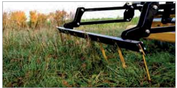
Insektenretter: durch einen speziell konzipierten, hydraulisch klappbaren Bügel mit integrierten abgewinkelten Zinken werden Insekten und Kleinstlebewesen vor dem Mulchgerät aufgescheucht und zur Flucht bewegt. (optional für Arbeitsbreiten von 2,0 m und 2,20 m)
