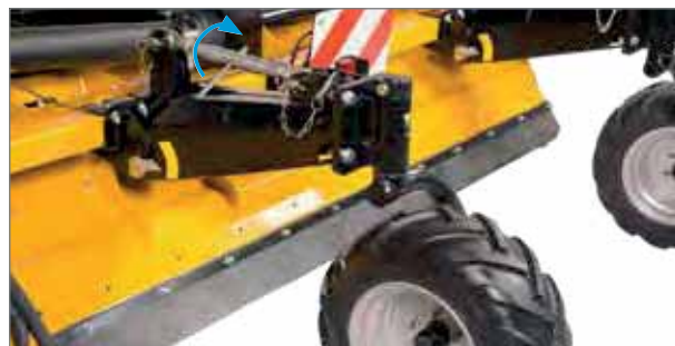
Mit dem Spannschloss stellen Sie schnell die richtige Schnitthöhe ein.
