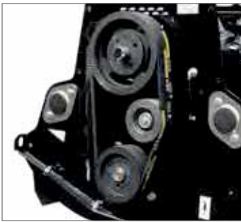
Störungsfreies und wartungsarmes Arbeiten durch effektiv ausgeführte automatische Riemenspannung.
