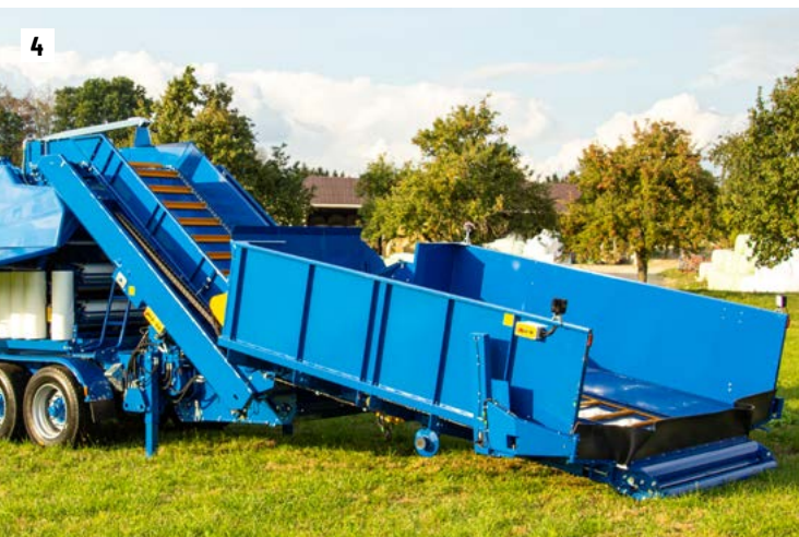
4 Wände des Steilförderers und des Zubringers aufklappen
