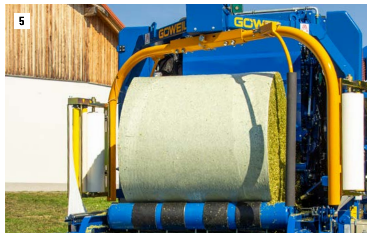
Der Ballen wird vom fahrbaren Wickeltisch abgeholt
