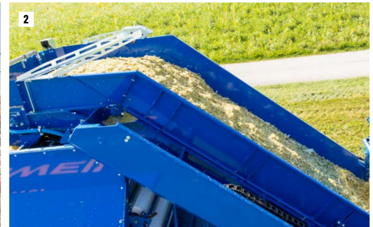
Perfekt dosiert gelangt das Material vom Zubringer zum Steilförderer
