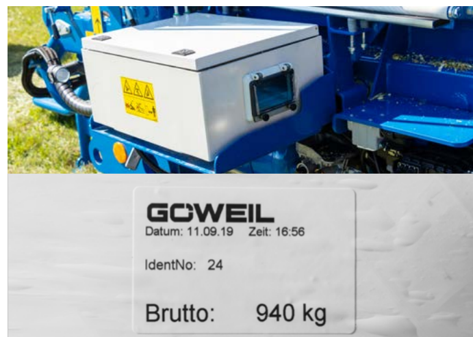
Etikettendrucker (oben) und Klebe-Etikett am Rundballen (unten)
