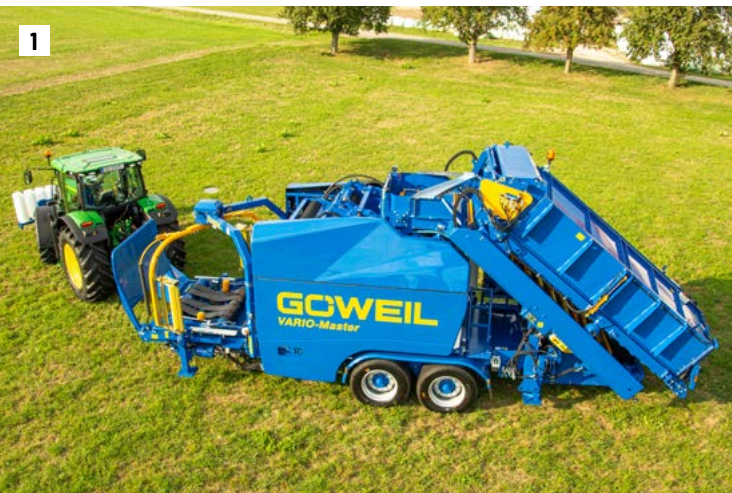
1 Richtige Positionierung der VARIO-Master und Ausschwenken der Deichsel
