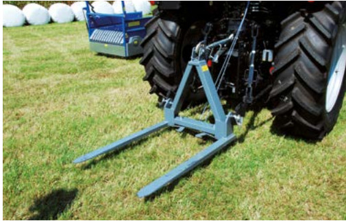
Abbildung 1 - Dreipunktanbau Kat. II mit Staplergabel
