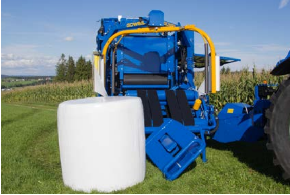
Ballenablage rampe mit Ballenaufsteller
