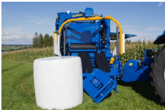
Ballenablage rampe mit Ballenaufsteller
