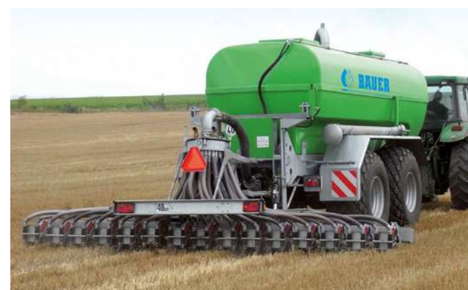
Dreiteilige ONE-way Schlitzscheiben ermöglichen einen exakten Schneidverlauf und weiten den Schlitz für die Gülle auf.
