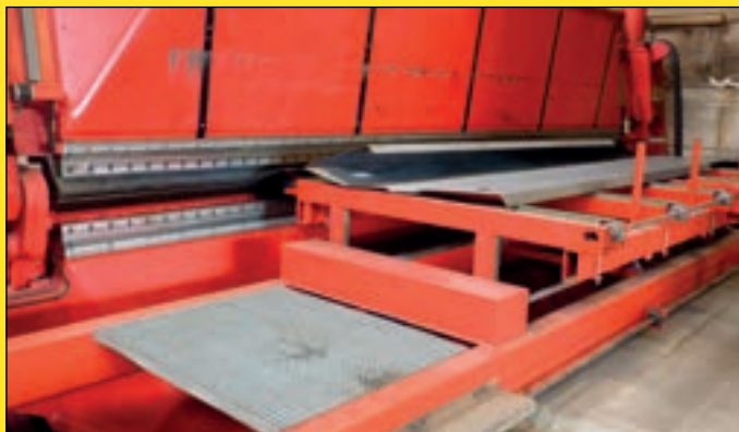
Digital gesteuerte Biegepresse mit einer Stärke von 600 Tonnen Biegekraft
