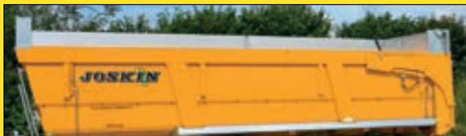
Kombination von Alu-Aufsätzen und eines hydraulischen Stahlaufsatzes (50cm)
