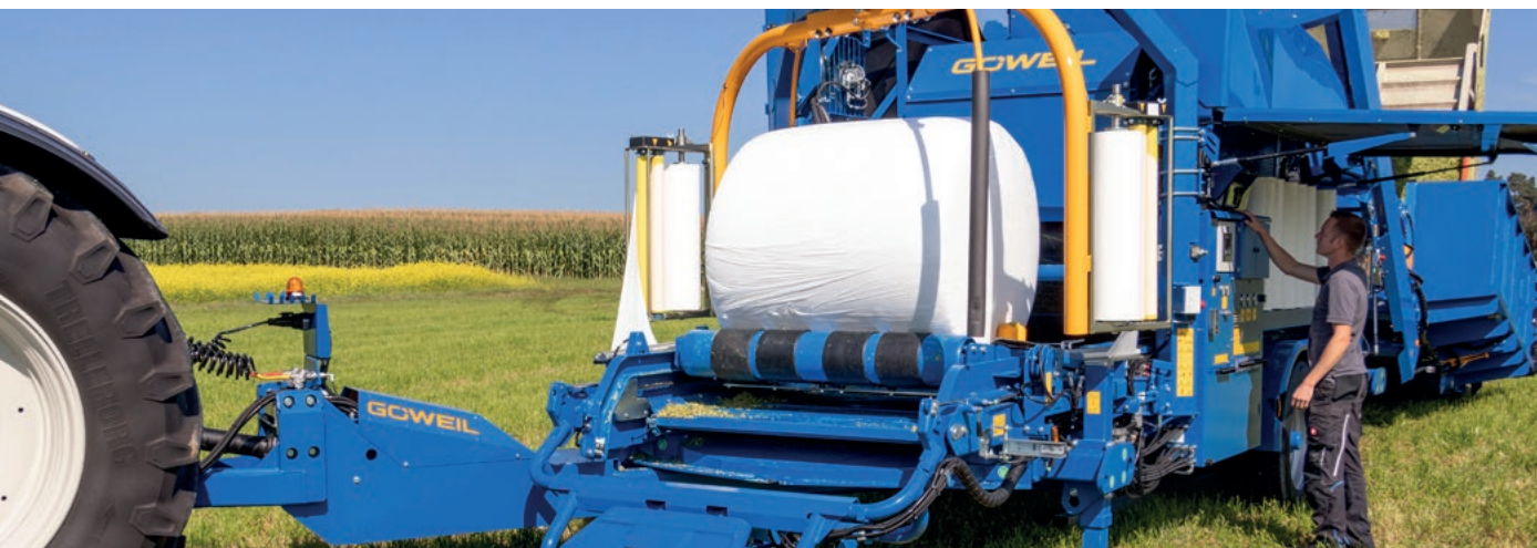
Wiegesystem mit vier integrierten Wiegezellen - geeicht und ungeeicht verfügbar
