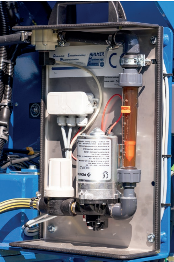
Bedieneinheit Dosistar, Pumpe mit Filter, elektronische Durchflussmessung
