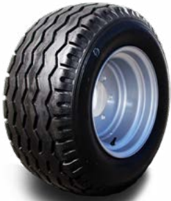
Kompletttrrad 300/80-15.3 10PR/6 Loch/ETO/Diagonal, AW
