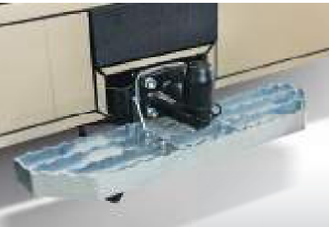
SICHERER EINSTIEG dank Anhängerkupplung mit Auftritt
