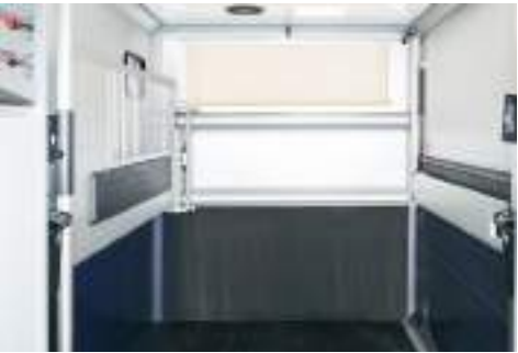
MAXIMALE FLEXIBILITÄT dank horizontal verschiebbarer Trennwand
