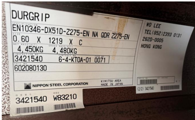
图 2 产品标签样本 ( 0.60 x 1219 x C ) 显示产品规格、尺寸、重量及追溯资料
