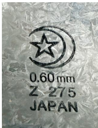
圖 1 產品表面標識樣本 ( 0.6mm / Z 275 ) 顯示品牌標識、厚度及鍍層資料
