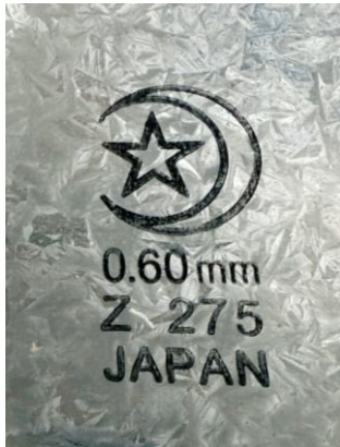
图 1 产品表面标识样本 ( 0.60mm / Z 275 ) 显示品牌标识、厚度及镀层资料
