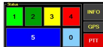
Mit der ‚PTT‘ Schaltfläche kann die Sprechfunktion des jeweiligen Funkgerätes betätigt werden. Als Mikrofon wird das in der Geräteprogrammierung festgelegte primäre Mikrofon verwendet. Je nach Beschriftung (z.B. bei Besprechungeinrichtungen / Funktischen) kann nicht garantiert werden, dass dieses auch wie gewünscht funktioniert. Für die Sprachtastensteuerung (PTT) ist mindestens die PRO Lizenz erforderlich.
