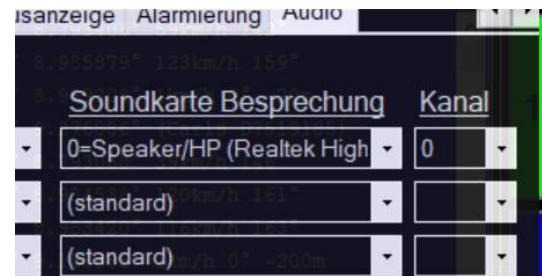
Auf dem TETRAcontrol Netzwerk-Client, muss das Mikrofon für die Besprechung korrekt konfiguriert sein.
