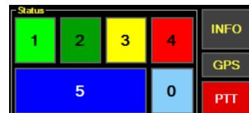
Mit der ‚PTT‘ Schaltfläche kann die Sprechtaste des jeweiligen Funkgerätes betätigt werden. Als Mikrofon wird das in der Geräteprogrammierung festgelegte primäre Mikrofon verwendet. Je nach Beschaltung (z.B. bei Besprechungseinrichtungen / Funktischen) kann nicht garantiert werden, dass dieses auch wie gewünscht funktioniert. Für die Sprachtastensteuerung (PTT) ist mindestens die PRO Lizenz erforderlich.
