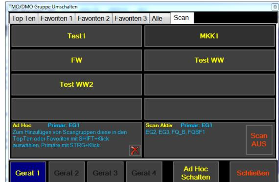
Eine Beschreibung des Dateiaufbaus befindet sich in der Datei. Prinzipiell besteht eine Scan-Liste immer aus einer primären Gruppe und bis zu 9 Scan-Gruppen. Bei den Scan-Gruppen kann die Scan-Priorität konfiguriert werden (Niedrig=3, Mittel=4, Hoch=5). Beim Klick auf eine der „Kurzwahltasten“ wird die jeweilige Scan-Liste sofort aktiviert und der Scan-Modus eingeschaltet.
