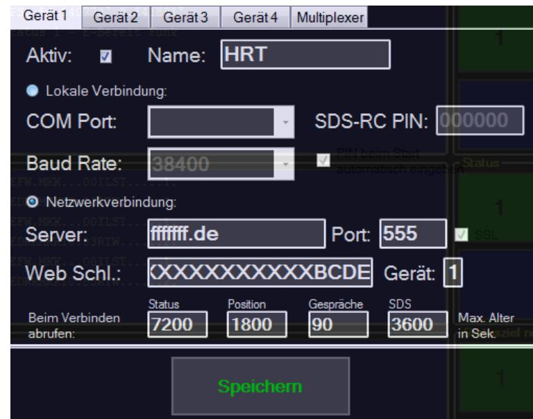
Allerdings kann bei Motorola und P8GR Geräten die Baudrate in TETRAcontrol auf 115200 eingestellt werden – TETRAcontrol stellt dann beim Verbinden die Geräte auf diese Geschwindigkeit ein, auch wenn in der Programmierung 9600 oder 38400 Baud eingestellt sind. Sepura Geräte unterstützen maximal 38400 Baud.
