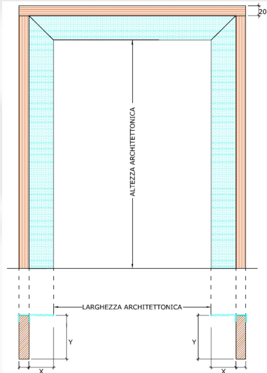
Per Y superiore a 160 mm il contro telaio verrà realizzato automaticamente in OSB 3
