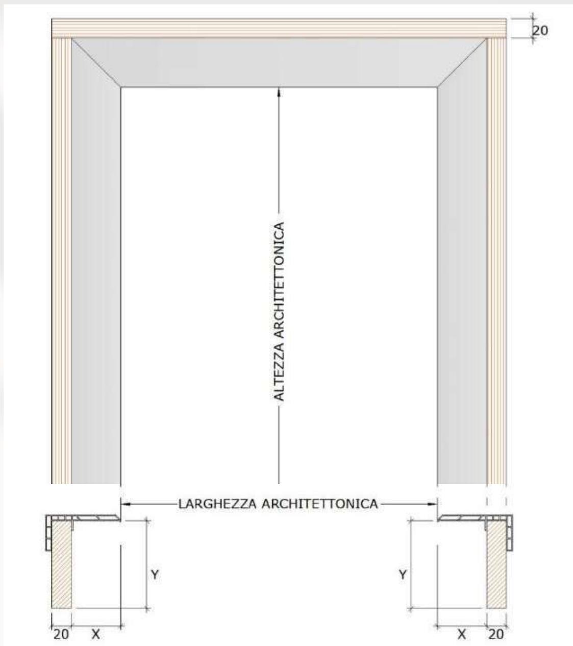
Per Y superiore a 160 mm il controtelaio verrà realizzato automaticamente in OSB 3
