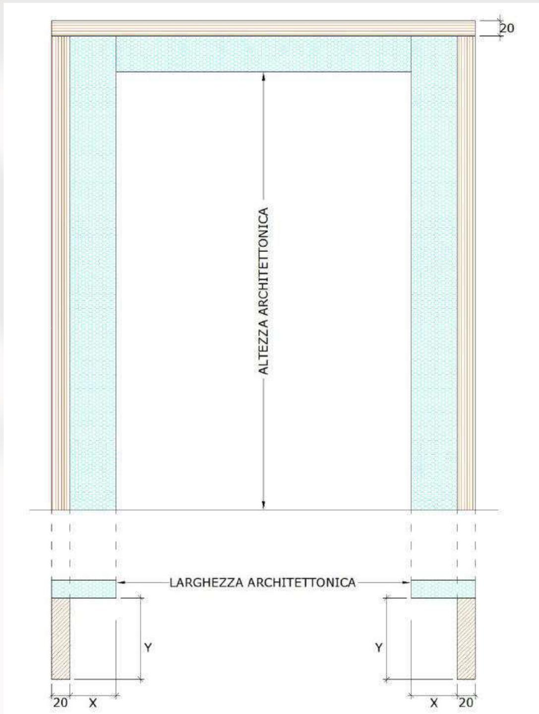
Per Y superiore a 160 mm il contro telaio verrà realizzato automaticamente in OSB 3
