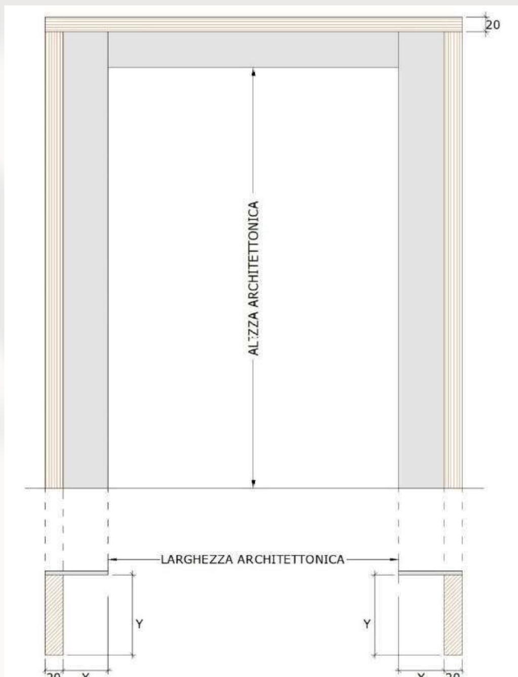
Per Y superiore a 160 mm il contro telaio verrà realizzato automaticamente in OSB 3
