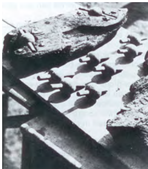
Onderdelen en samenstellingstekening van een houten taatslager met bronzen kogels uit de tijd van Keizer Caligula (40 n. Chr.)
