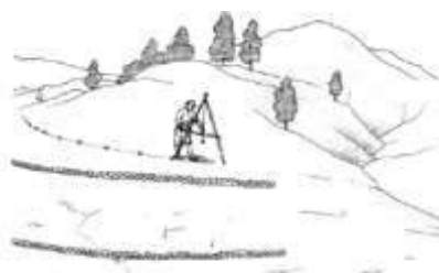
Trazando una zanja de coronación con 1% de caída.
