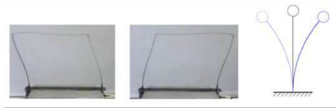
Figura 1. Vibración de un pórtico de un piso o péndulo simple.
