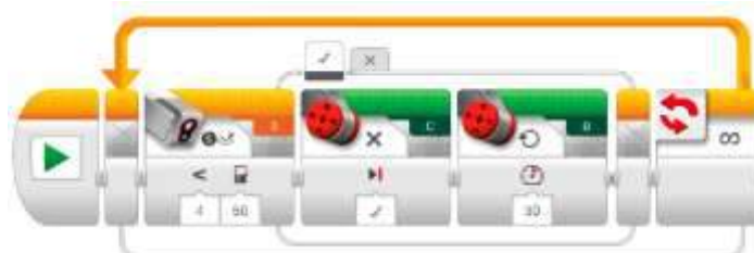
Figura n.º 1: Programa de funcionamiento del motor de un robot controlado con un sensor.
