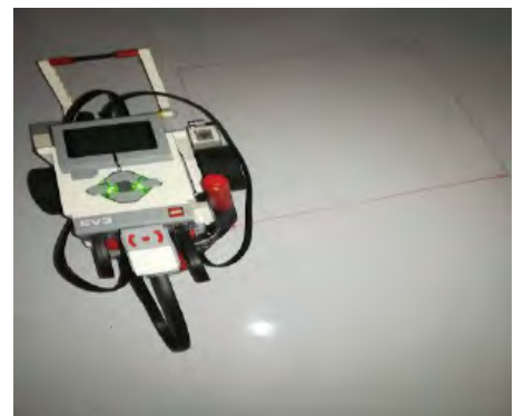
Figura 10. Robot Ev3 realizando el trazo de un cuadrado
