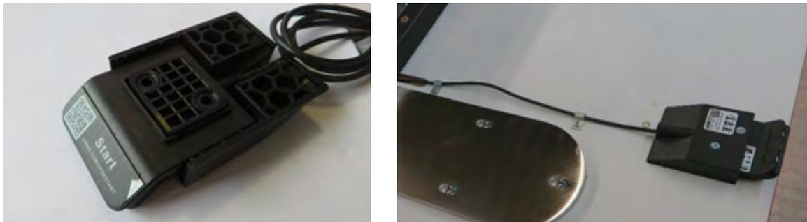
Legen Sie das Kabel in die Nut in der Tischplatte und fixieren Sie an den vorgesehenen Punkten. Kabel nicht festziehen, sondern locker führen. Die Funktion des Handschalters ist sonst beeinträchtigt.
