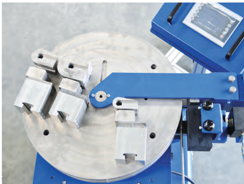
Dornbiegewerkzeuge in unterschiedlichen Größen, maximaler Radius 270 mm und minimaler Radius 9 mm auf den Maschinen der 5000er Serie
