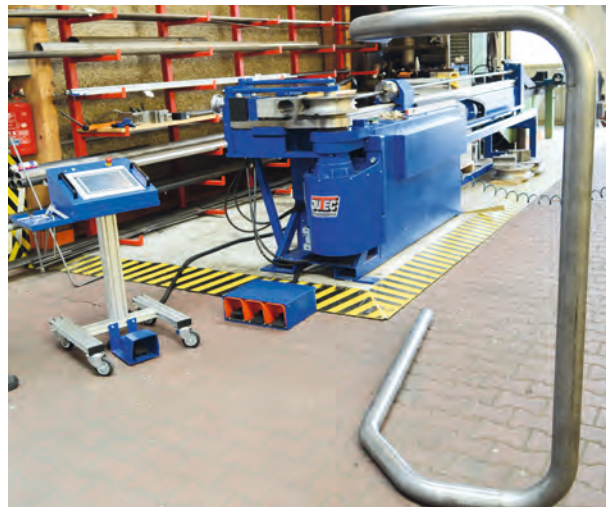
Biegeleistung bis 100 mm mit Dornbieger 9000 möglich
