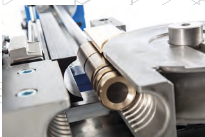
Dornbiegewerkzeug mit Kugeldorn, Faltenglätter und mitlaufender Gleitschiene
