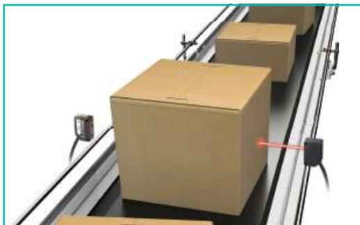
Manejo de materiales — Los sensores fotoeléctricos, como los de esta Serie 9000, se usan en todas las etapas del proceso de envasado para confirmar la presencia y la posición del contenedor.
