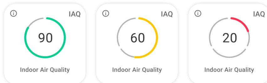
Está basado en el RESET AIR INDEX, y muestra el estado de la calidad del aire interior de un espacio en una escala de 0 a 100. Proporciona una manera fácil y visual de verificar la calidad del aire en tiempo real en un espacio determinado, ofreciendo recomendaciones de mejora adicionales y permitiendo seguir la evolución de la calidad del aire a lo largo del tiempo seleccionado.
