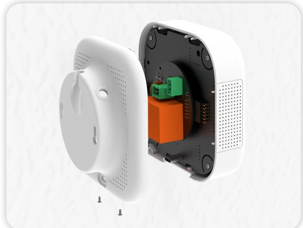
Desacopla la tapa trasera del MICA
