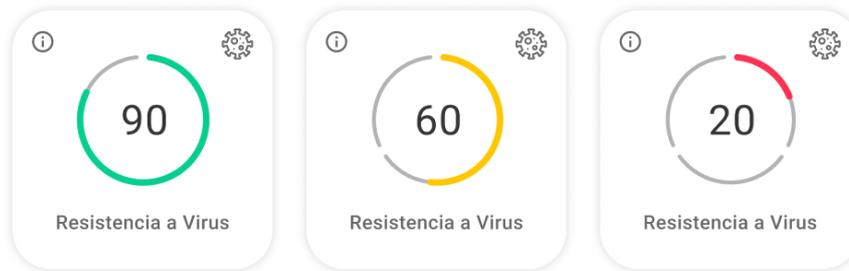
Indica la probabilidad de propagación aérea de virus en un espacio interior. Basado en el RESET VIRAL INDEX, muestra en una escala 0-100 la resistencia que ofrece el aire de un espacio a la propagación de virus. El indicador calcula el potencial de infección basándose en métricas de calidad del aire interior científicamente contrastadas, como la temperatura, la humedad relativa, la concentración de PM2.5 y el CO<sub>2</sub>, evaluadas a través de la tecnología de monitorización de inBiot.
