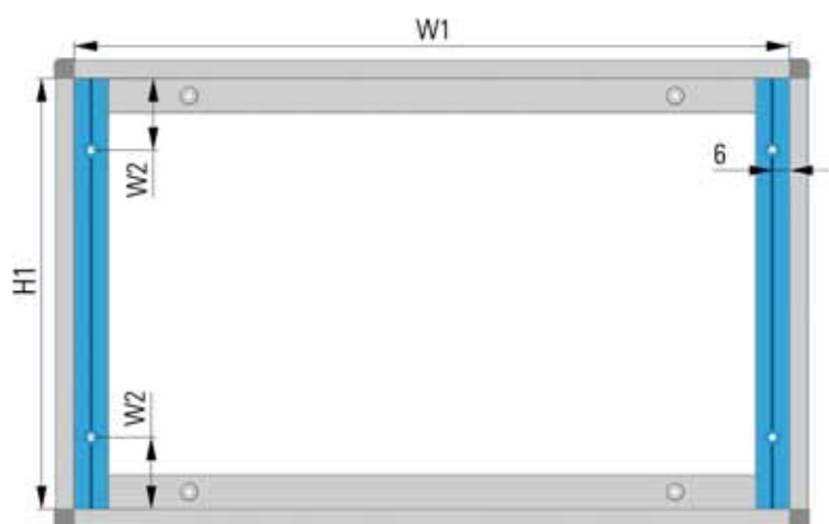
Vue arrière pour châssis constitué de profilés d'une profondeur D1 = 130 mm
