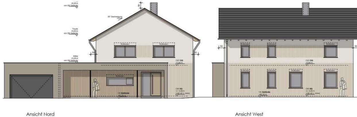
Es sind zwei Vollgeschosse EG und OG und ein Dachgeschoss mit Pfettendach geplant. Das Dachgeschoss erhält keine Nutzung und wird als Spitzboden geplant.
