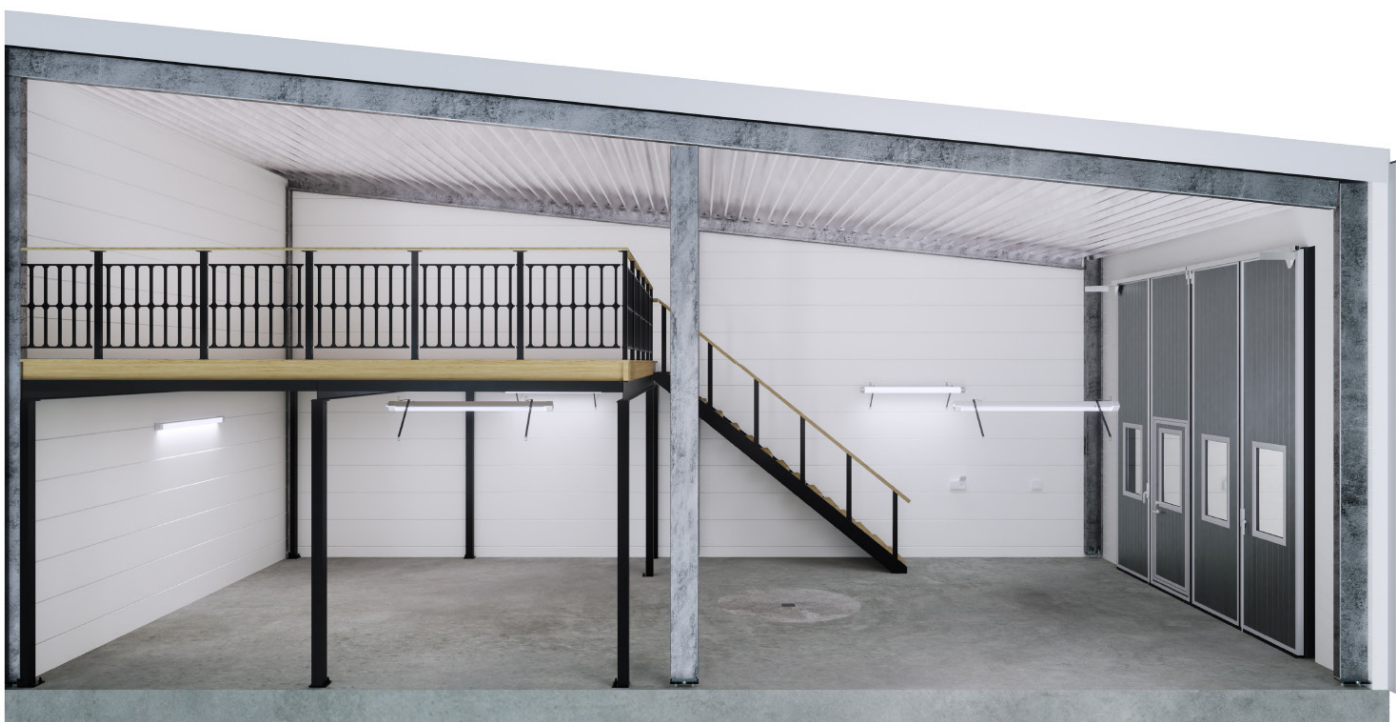
Placering av ljuskällor med entresol med utanpåliggande trappa
