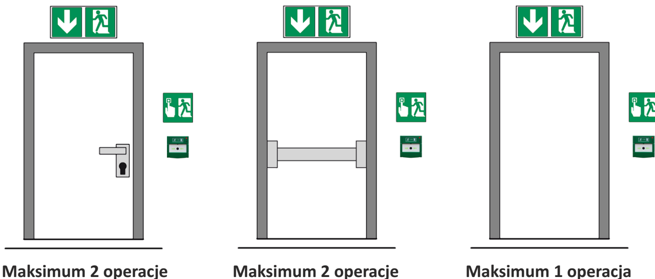
Rys. 9. Przykłady rozwiązań ewakuacyjnych przypisanych do kategorii B i maks. dopuszczona liczba prostych operacji [na podstawie normy PN-EN 13637:2015-07]
