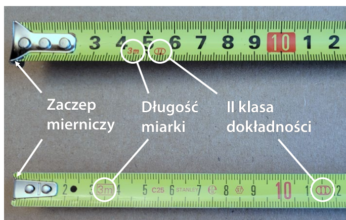
Rys. 27. Przykłady oznakowanie przymiarów zwijanych [zdjęcie autora]
