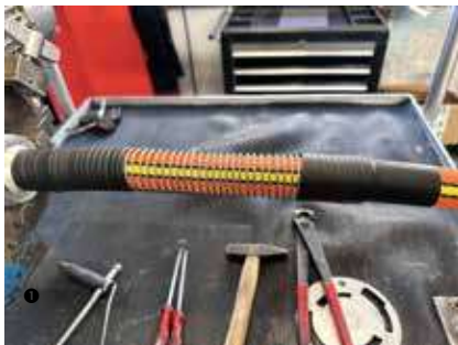
❶ Schrumpfschläuche müssen am Stutzen vorne an der Metallknickschutzspirale und zur Hälfte über das Ende der Metallknickschutzspirale verschmolzen sein ❷ Fertig eingebundener GH TEXFLEX X-TREME.
