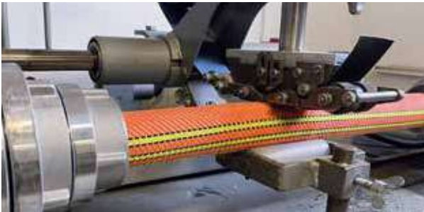
Links: Abriebtest Oben: Schlauch nach Abrieb
