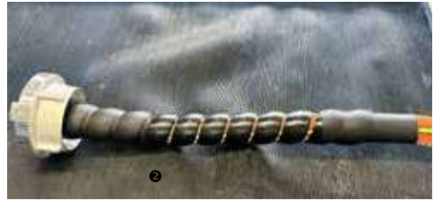
❶ Knagge und den Sperring fest montieren ❷ Fertig eingebundene Seite mit der Kunststoffknickschutzspirale
