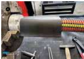
❶ Metallknickschutzspirale über den Schlauch ziehen, dabei vorsichtig die Spirale leicht aufdrehen ❷ Knagge, Sperring und 2 Schrumpfschläuche über den Schlauch ziehen ❸ 1,8 mm Draht mit 2 x 6 Windungen wickeln, mit einer Verbindungskette zwischen den 2 Einbindefeldern ❹ Schrumpfschläuche auf die Metallknickschutzspirale am Knagge vorseiten und am Ende der Spirale aufschieben ❺ mit einer Heißluftpistole den Schrumpfschlauch langsam erhitzen ❻ Nun im Endbereich der Metallknickschutzspirale einen Schrumpfschlauch aufsetzen und auch mit der Heißluftpistole langsam erhitzen.
