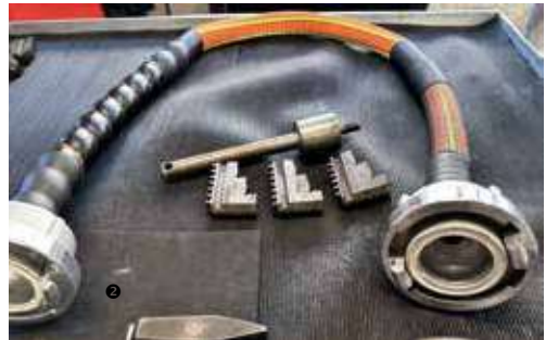
❶ Schrumpfschläuche müssen am Stutzen vorne an der Metallknickschutzspirale und zur Hälfte über das Ende der Metallknickschutzspirale verschmolzen sein ❷ Fertig eingebundener GH TEXFLEX X-TREME.
