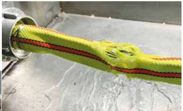
Ohne Abrieb geplatzter Feuerlöschschlauch
