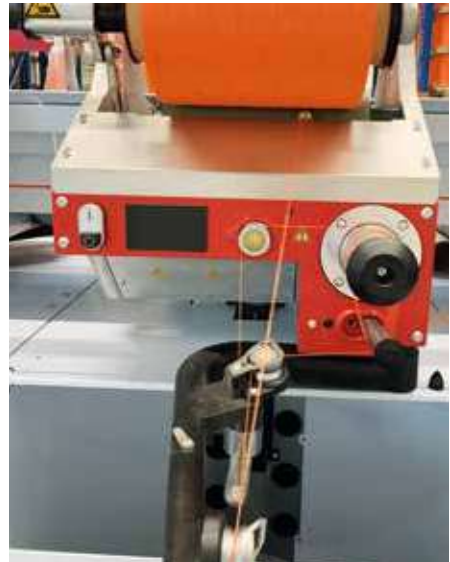
Bild rechts: Zwirnen des Vielfachgarnes zu einem Faden
