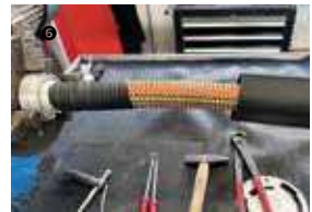
❶ Metallknickschutzspirale über den Schlauch ziehen, dabei vorsichtig die Spirale leicht aufdrehen ❷ Knagge, Sperring und 2 Schrumpfschläuche über den Schlauch ziehen ❸ 1,8 mm Draht mit 2 x 6 Windungen wickeln, mit einer Verbindungskette zwischen den 2 Einbindefeldern ❹ Schrumpfschläuche auf die Metallknickschutzspirale am Knagge vorseiten und am Ende der Spirale aufschieben ❺ mit einer Heißluftpistole den Schrumpfschlauch langsam erhitzen ❻ Nun im Endbereich der Metallknickschutzspirale einen Schrumpfschlauch aufsetzen und auch mit der Heißluftpistole langsam erhitzen.
