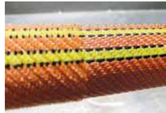
Links: Abriebtest Oben: Schlauch nach Abrieb
