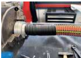
❶ Metallknickschutzspirale über den Schlauch ziehen, dabei vorsichtig die Spirale leicht aufdrehen ❷ Knagge, Sperring und 2 Schrumpfschläuche über den Schlauch ziehen ❸ 1,8 mm Draht mit 2 x 6 Windungen wickeln, mit einer Verbindungskette zwischen den 2 Einbindefeldern ❹ Schrumpfschläuche auf die Metallknickschutzspirale am Knagge vorseiten und am Ende der Spirale aufschieben ❺ mit einer Heißluftpistole den Schrumpfschlauch langsam erhitzen ❻ Nun im Endbereich der Metallknickschutzspirale einen Schrumpfschlauch aufsetzen und auch mit der Heißluftpistole langsam erhitzen.
