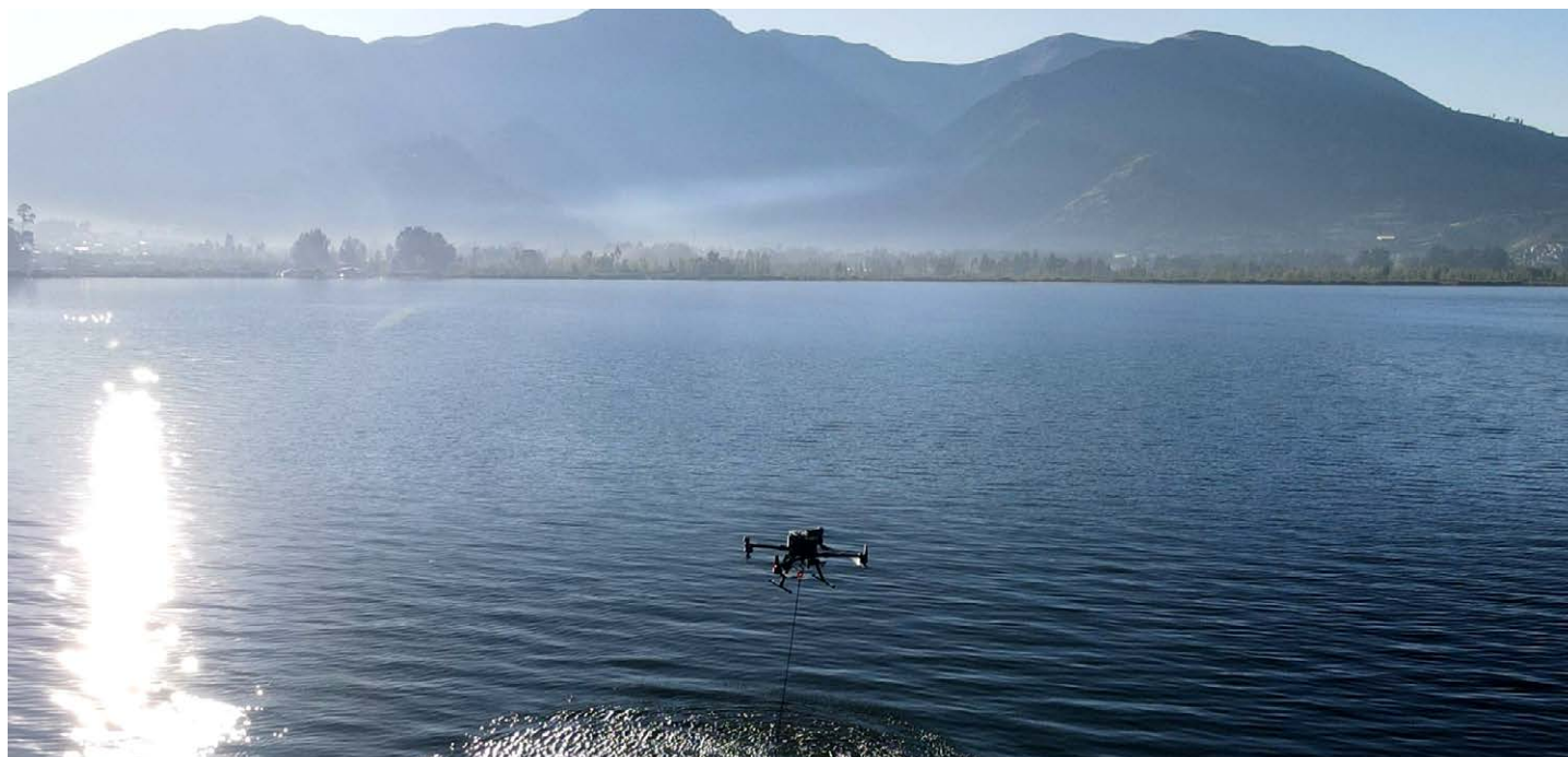
Dron DJI RTK M300 Integrado con la Ecosonda de SPH Engineering durante el levantamiento en la laguna
