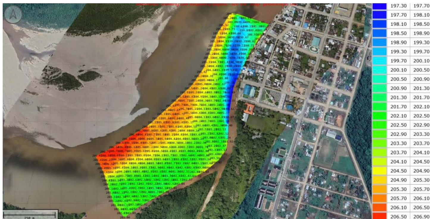
Matriz de elevación del lecho del río generada con Hydromagic
