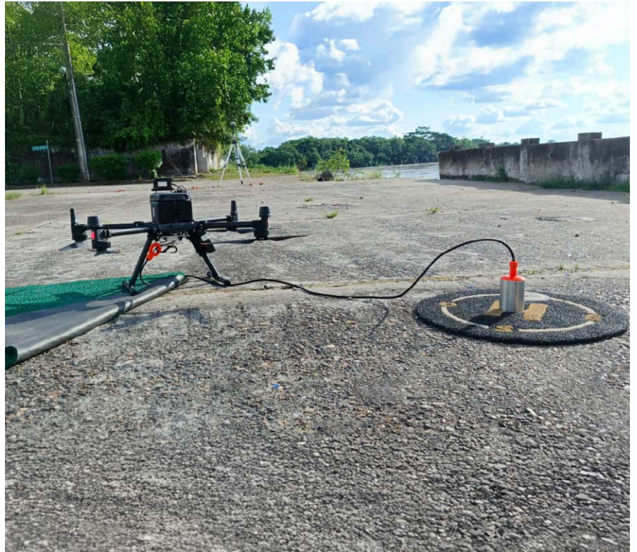
Ecosonda ECT D052S de doble frecuencia montada en un dron DJI M350
