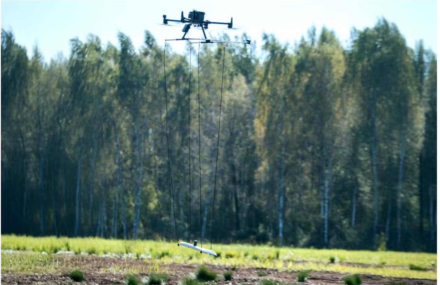
Figura 4. Configuración del magnetómetro Geometrics MagArrow II.
