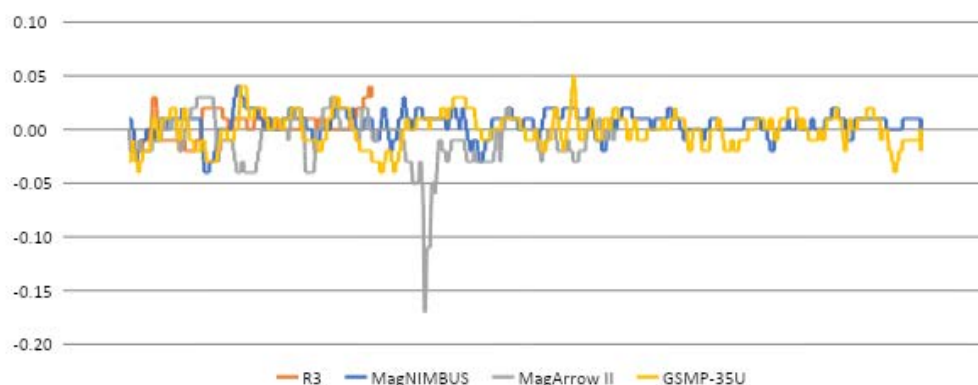
Figura 18. Variaciones de la altitud sobre el nivel del suelo (en centímetros) con el recuento de muestras. Las variaciones se calculan en intervalos de 20 centímetros, ya que cualquier anomalía causada por variaciones de altitud en distancias más cortas se filtraría de todos modos durante el procesamiento de los datos. El recuento de muestras de los sensores difiere debido al tiempo de vuelo (véase la siguiente sección).
