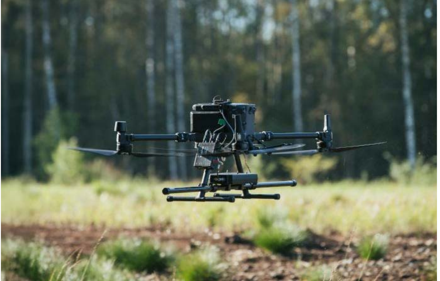
Figura 3. Configuración del magnetómetro SENSYS MagDrone R3.
