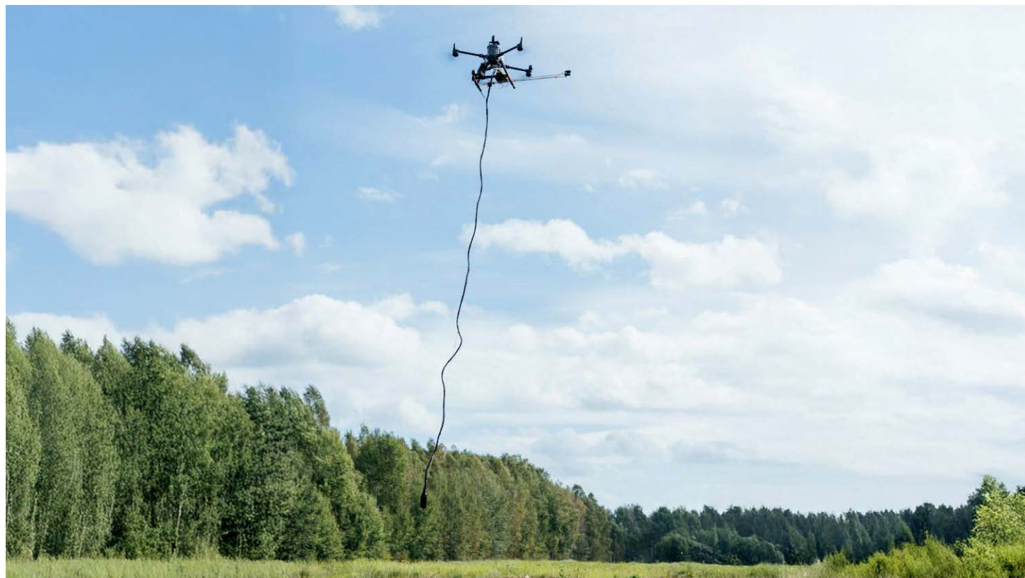
Figura 5. Configuración del magnetómetro DRONEmag GSMP-35U de GEM Systems.
