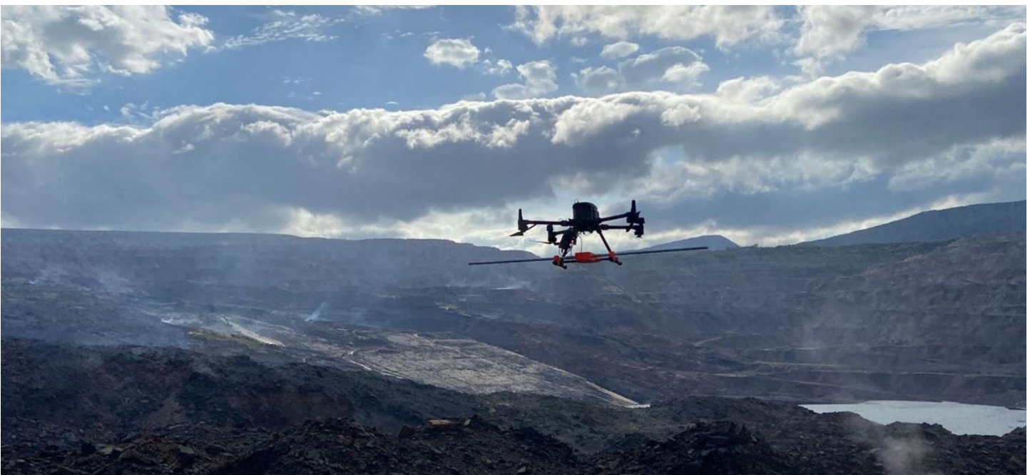
El Zond Aero LF fue la mejor opción entre otros GPR para lograr el objetivo mencionado. Es capaz de alcanzar las profundidades geológicas especificadas por el cliente, lo que lo hace adecuado para identificar cavidades subterráneas de manera segura.
