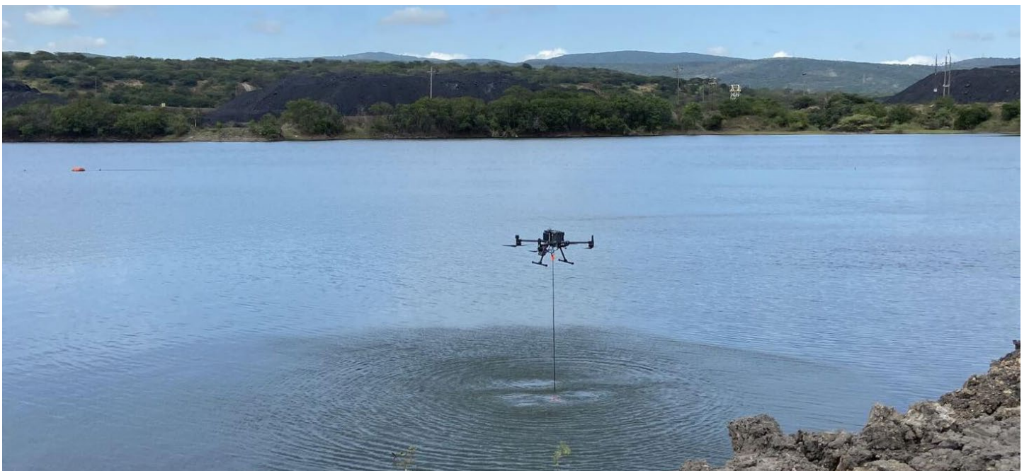
Ecosonda de doble frecuencia ECT D052S montada en un dron DJI M300 durante el levantamiento de uno de los reservorios de agua de la mina
