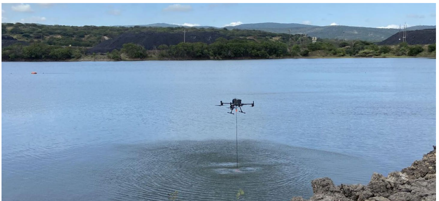
在勘测矿山水库期间，安装在 DJI M300 无人机上的 ECT D052S 双频回声测深仪
