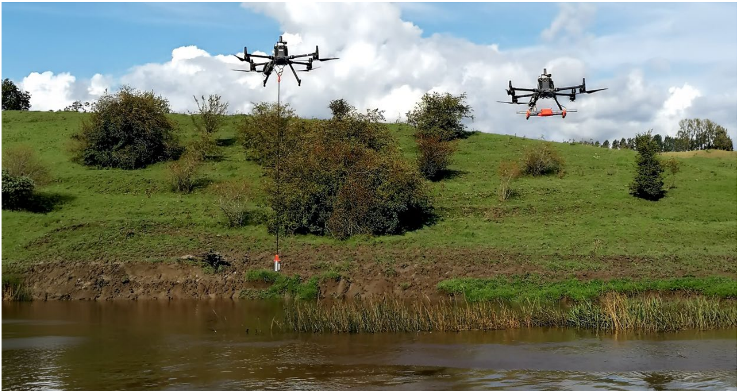
现场部署搭载 ECT400S 回声测深仪 ( 左 ) 和 Zond Aero LF WPR ( 右 ) 的 M300 无人机。
