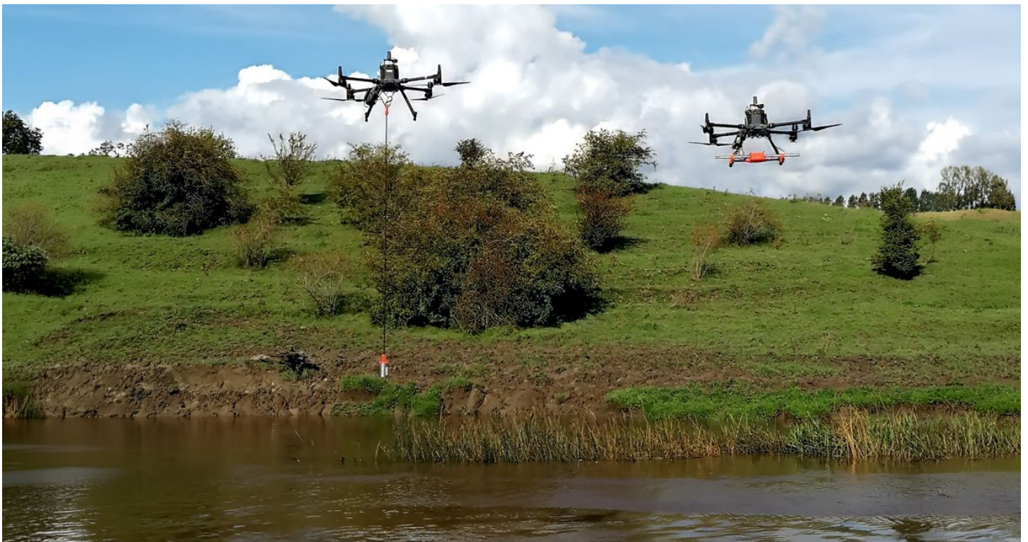
Despliegue en campo del dron M300 con la ecosonda ECT400S (izquierda) y el WPR Zond Aero LF (derecha).
