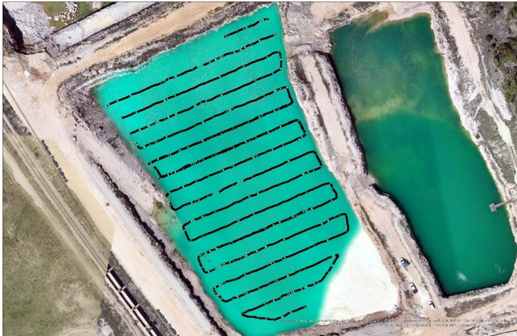
在 Knife River 采石场进行无人机水深测量期间，在 UgCS 中规划并执行了网格飞行路径
