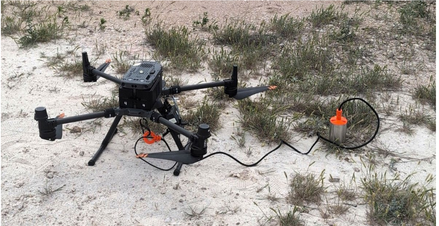
在 Knife River 采石场，配备 SPH Engineering 双频回声测深系统的大疆经纬 350 无人机
