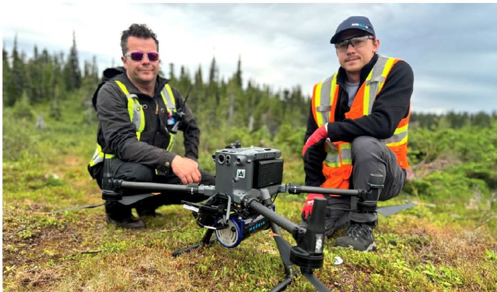
Ilustración: Técnicos de Altomaxx preparando la plataforma VANT con el espectrómetro de rayos gamma Medusa MS350 antes de las operaciones de estudio.
