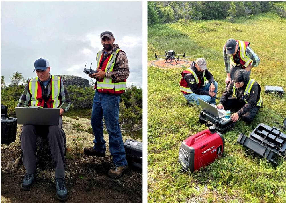
图片说明：Altomaxx 团队正在执行放射性测量作业，在笔记本电脑上查阅任务参数，检查 SkyHub 数据，并为基于无人机的伽马射线数据采集准备设备。
