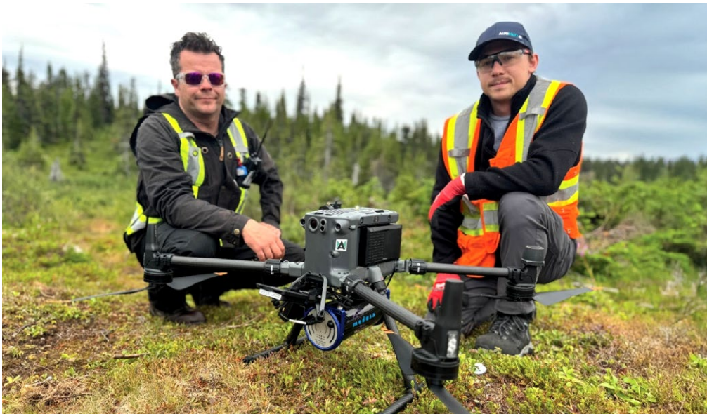
图片说明：Altomaxx 技术人员在勘测作业前，为搭载 Medusa MS350 伽马射线能谱仪的无人机平台做准备。
