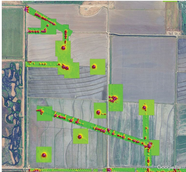
Ilustración: Resultados del estudio magnético que destacan la detección de tuberías horizontales asociadas con la infraestructura de gas abandonada.
