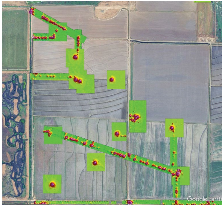
图片说明：磁力测量结果突出了与废弃天然气基础设施相关的水平管道的检测。
